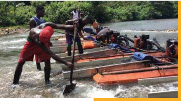
Minidragas en fila trabajando. Por tratarse de un río de piedras y arenas gruesas en excelente estado, los canalones están vertiendo aguas limpias al río CCC Río Yurumanguí. © C. Echavarría, 2016.
