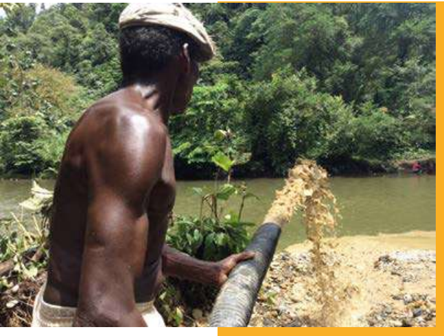
Mala práctica de vertimiento de agua del desaguado de un timbo directamente al río. CCC Río Yurumanguí. © WWF / C. Echavarría, 2016.
