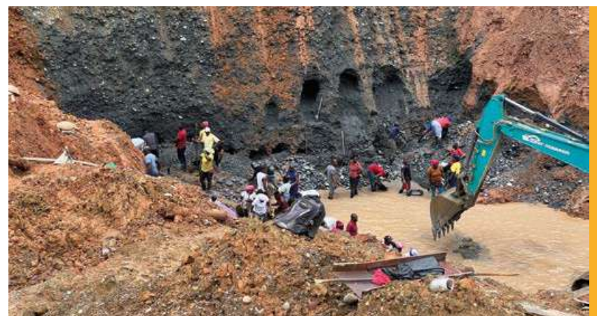
Barequeros trabajando junto a la retroexcavadora en el sector de Hueco Oscuro, Tadó. Nótese las tucas excavadas en los frentes de las retos por los barequeros. © WWF / J. C. Megía
