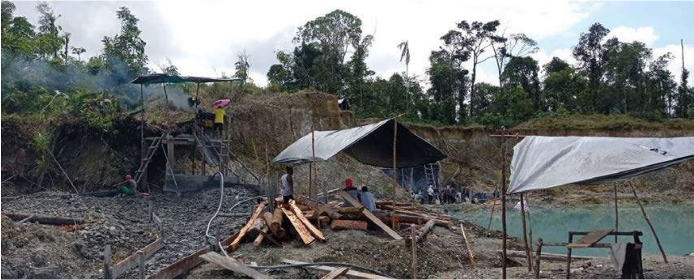
Área minera que muestra distintas zonas de servicios para dos hoyos guache en operación. Nótese a la izquierda la torre del malacate, el motor de achique echando humo, en el centro el área de las maderas, el tambor a la derecha y al fondo las personas en la entrada de otro guache. Se reportan aproximadamente 90 personas trabajando en estas dos minas. Unión Panamericana, Chocó. © WWF / J. C. Megía, 2024
