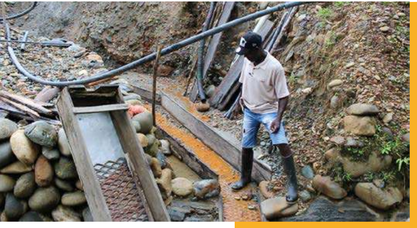
Américo Mosquera instalando un canalón metálico en su mina de agua corrida. Nótese que la curva del canalón y el recorrido son lo más largos posible para rodear la mina y asegurar una mejor recuperación de los metales. ©WWF / A. Ruiz.
