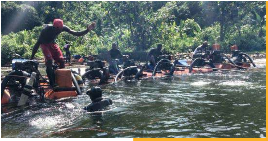
Fila de draguetas trabajando, nótese que los maquinistas y ayudantes permanecen largas horas respirando el material particulado. Yurumanguí. © WWF / C. Echavarría, 2016.
