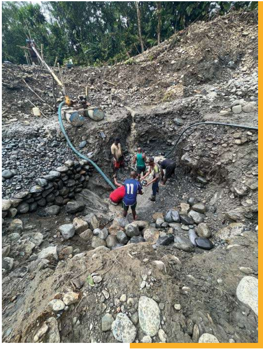
Mina de hoyadero con el sistema de bomba draga. Nótese la minidraga utilizada como bomba draga y la restauración del terreno al lado izquierdo del hoyo a medida que avanzan hacia la derecha. Playa de Oro, CC ASOCASAN, Choco. © WWF / C. Echavarría, 2022.
