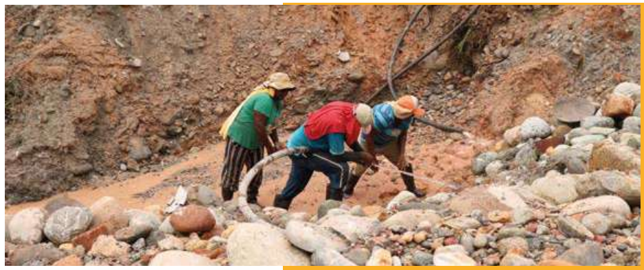
Mina de agua corrida con apoyo de chorros.
