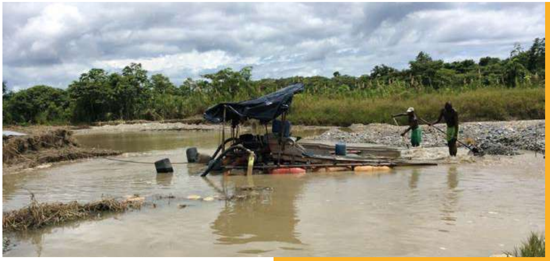
Minidragas trabajando dentro de una poza formada por retroexcavadoras en el CC Unión Panamericana. © WWF / C. Echavarría.
