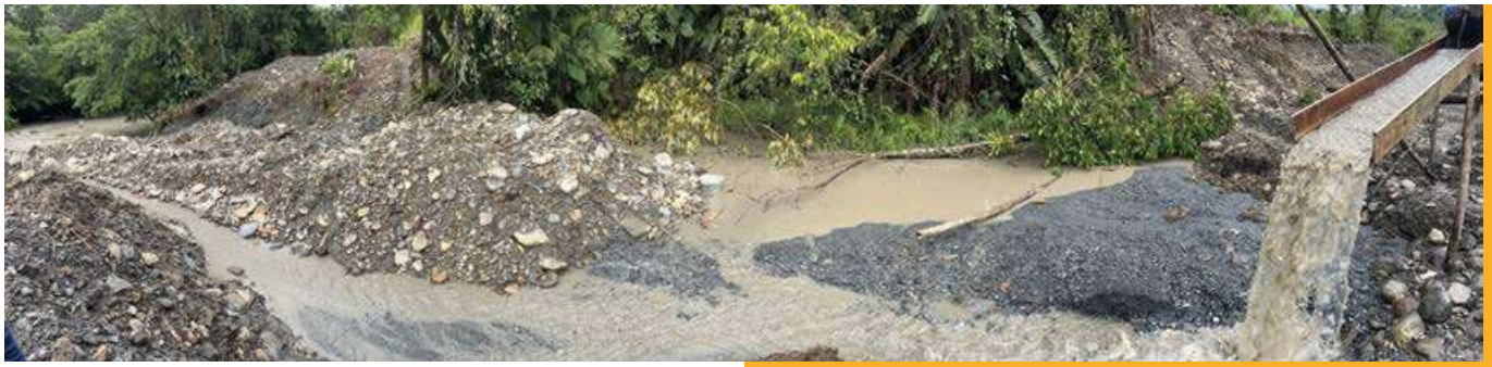
El agua es la principal fuente de energía para separar el oro de los lodos y arenas, Playa de Oro, Tadó. © WWF / C. Echavarría.
