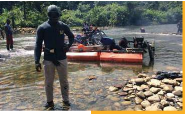
Los buzos operan una manguera bajo el agua que succiona las arenas y gravillas auríferas del fondo desde las minidragas. CCC Río Yurumanguí, 2016. © WWF / C. Echavarría.
