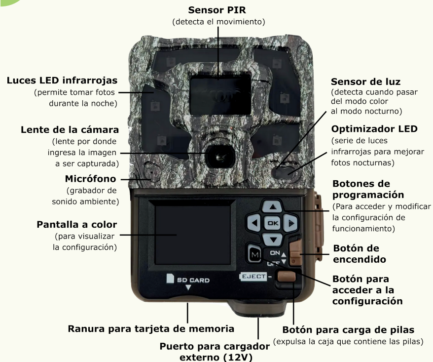
Imagen 1. Cámara trampa y sus partes. Las partes y su ubicación en el equipo pueden diferir entre modelos.
