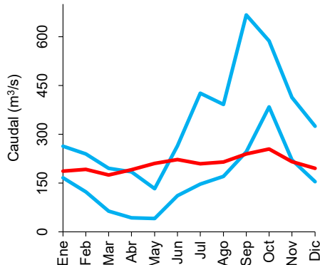
Figura 6. Desempeño del régimen de caudales sujeto a evaluación (1972–2014) del río Carrizal en la estación hidrométrica González (clave 30062) con relación a los límites inferior y superior establecidos conforme al periodo de referencia de 1957–1971 (líneas azules, percentiles 10 y 90, respectivamente). (a) Régimen de caudal medio mensual 1972–2014 y (b) anual (línea roja). Fuente: Elaboración propia.
