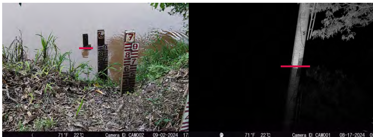
Figura 33. Identificación del nivel a la lámina de agua en condiciones diferentes. Fotografías: Proyecto “Construyendo bases para el monitoreo remoto-digital de caudales ecológicos para la gestión del agua”.
