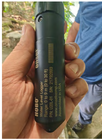
Figura 29. (a) Ancla prefabricada donde (b) el sensor barométrico Hobo U20L-01 (b) se encuentra instalado. Fotografías: Proyecto “Construyendo bases para el monitoreo remoto-digital de caudales ecológicos para la gestión del agua”.
