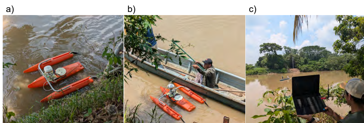
Figura 23. Operación para el uso del perfilador acústico de corriente Doppler. (a) Descarga del equipo de la embarcación al río. (b) Acomodo e inicio del recorrido sobre la sección transversal. (c) Recepción de datos a través de antena y seguimiento a la toma de datos en tiempo real en software especializado desde una computadora en alguna de las márgenes del río. Fotografías: Proyecto “Construyendo bases para el monitoreo remoto-digital de caudales ecológicos para la gestión del agua”.
