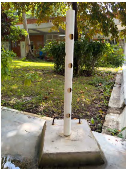
Figura 29. (a) Ancla prefabricada donde (b) el sensor barométrico Hobo U20L-01 (b) se encuentra instalado. Fotografías: Proyecto “Construyendo bases para el monitoreo remoto-digital de caudales ecológicos para la gestión del agua”.
