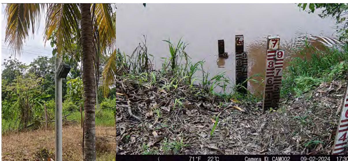
Figura 31. Instalación de cámara automática y ejemplo de fotografía de referencia. Fotografías: Proyecto “Construyendo bases para el monitoreo remoto-digital de caudales ecológicos para la gestión del agua”.
