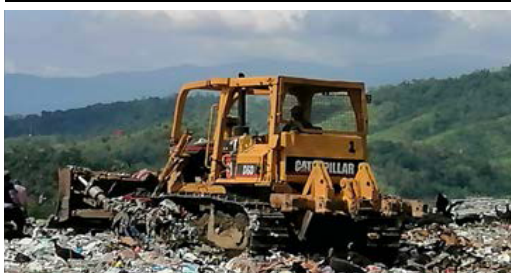
Compactado de los residuos, foto DIRSSE/MSPS
