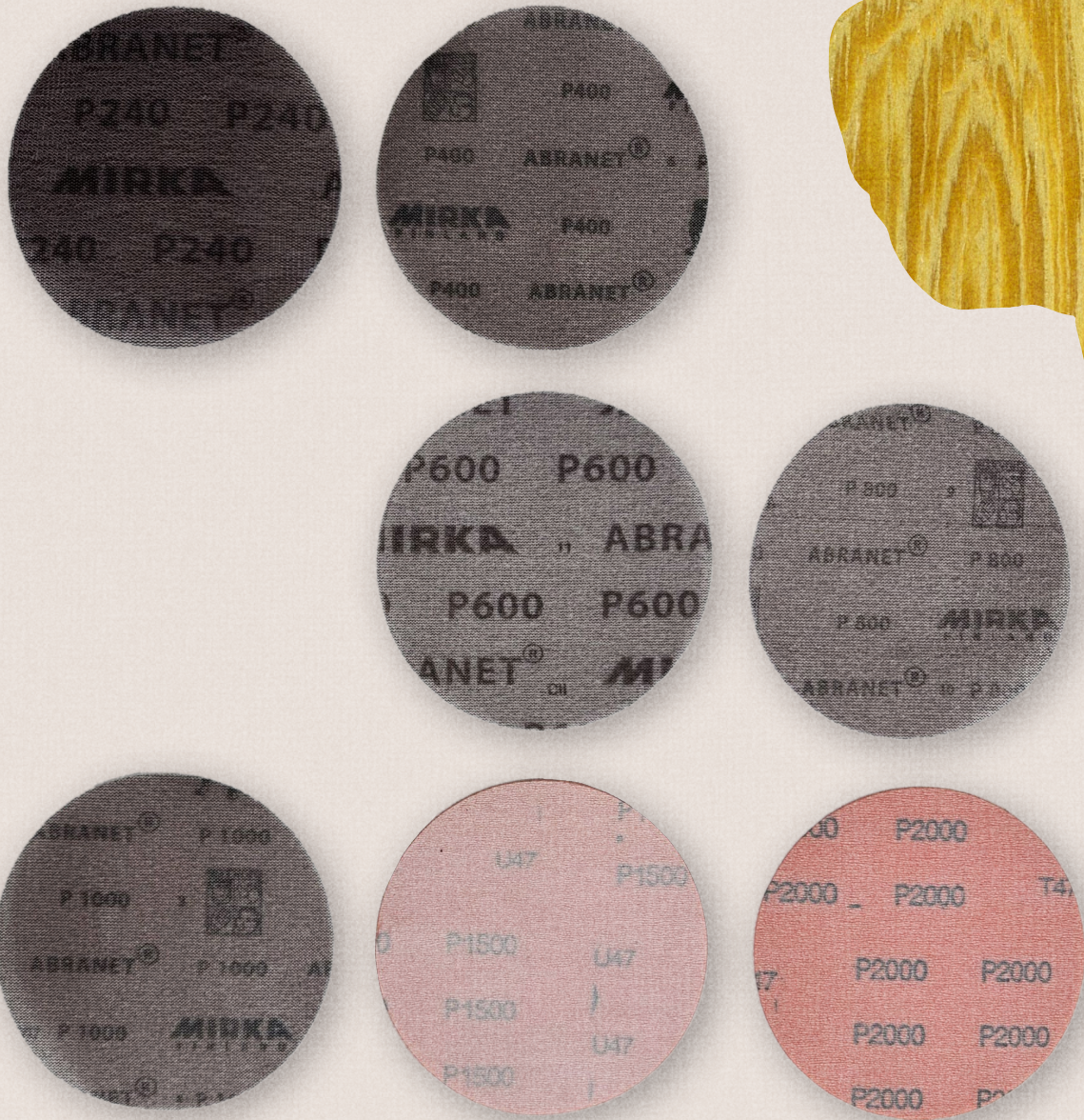
Figura 25. Lijas de diferente grano, necesarias para la obtención del plano transversal
