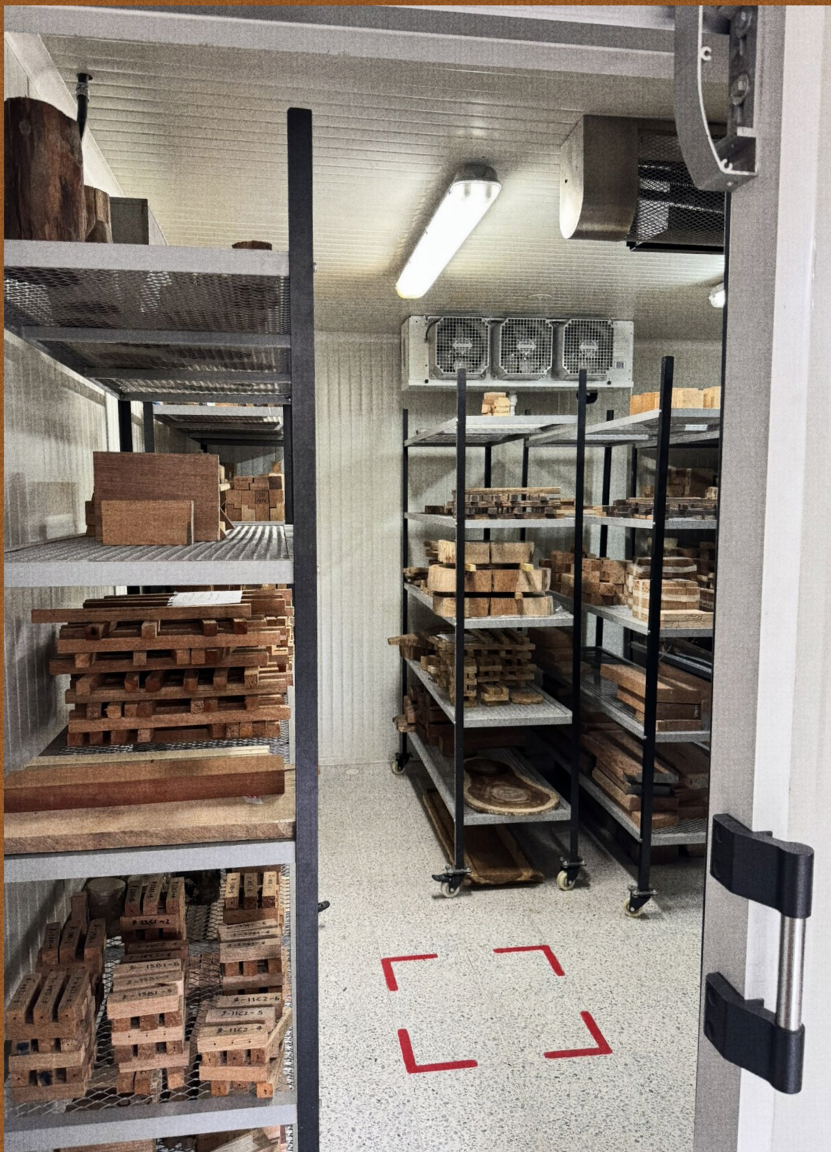
Figura 22. Probetas dispuestas en cuarto climático
