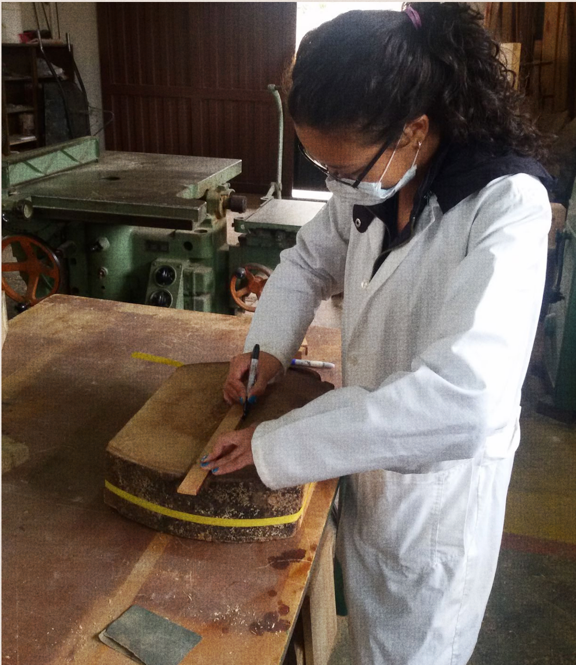
Figura 20. Marcación de códigos para la obtención de probetas de las muestras colectadas
