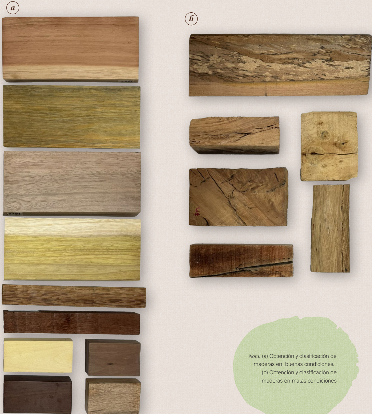
Figura 21. Obtención y clasificación de probetas
