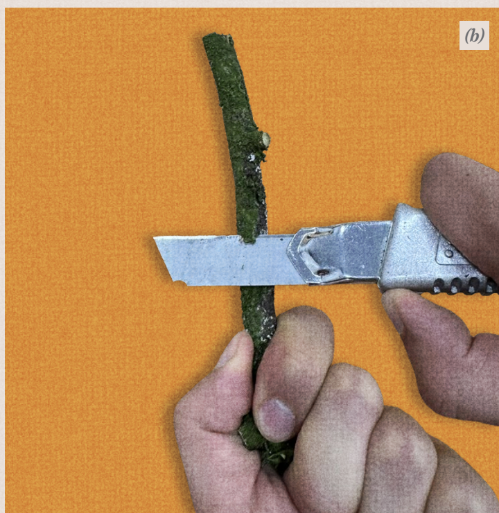
Figura 12. Obtención de muestras de madera de ramas
