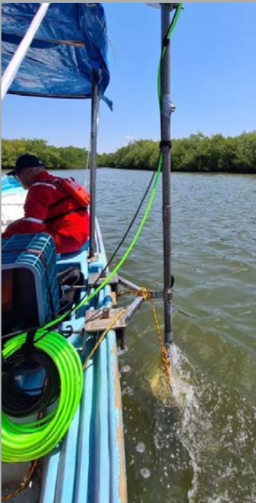
Realización de aforos de agua y sedimentos mediante tecnología Doppler.
