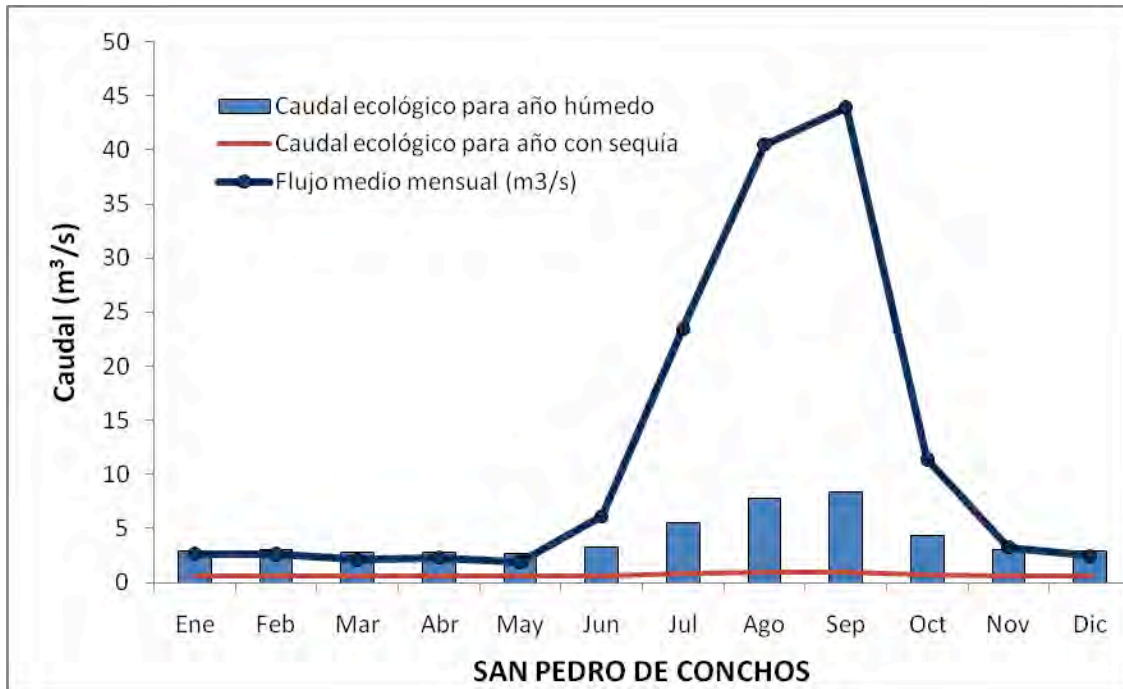
Figura 26. Comparación del CE en el flujo del sitio San Pedro de Conchos. Hidrograma del flujo medio mensual construido con el balance hídrico histórico de entradas a presa Francisco I. Madero (1937-2004)
