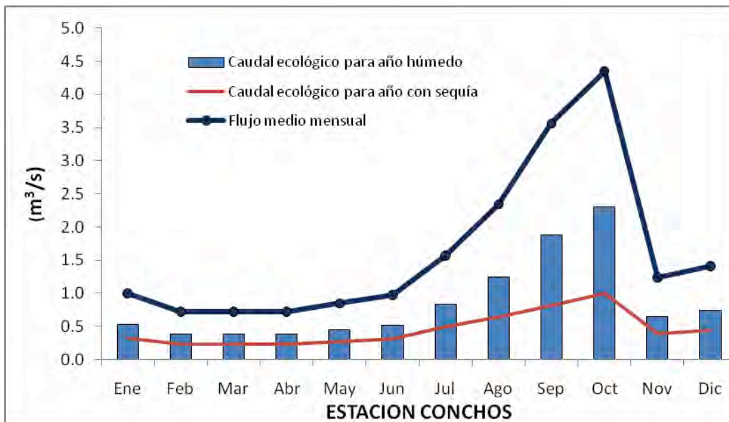
Figura 25. Comparación del CE contra el flujo medio mensual del sitio Estación Conchos. Hidrograma del flujo medio fue construido con la base de datos de la estación hidrológica Estación Conchos.
